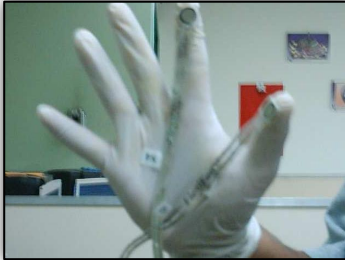
Fig. 6.3. Subjecció dels sensors als dits índex i polze [7]
